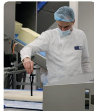
Les lignes Radini sont munies de fonctionnalités de contrôle de production: le réglage automatique des ouvertures et les contrôles amont-aval synchronisent les paramètres de fabrication pour une pâte optimale et sans contraintes internes. Ce système en cascade garantit un produit régulier et de haute qualité.
