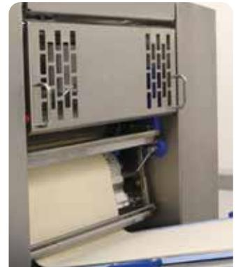
*Radini Linien sind mit modernen Prozessüberwachungsfunktionen ausgestattet: eine automatische Spaltverstellung und eine Ein- und Auslaufsteuerung synchronisieren die Einstellungen der Produktionslinien, um ein optimales, spannungsfreies Teigband zu erzeugen. Dieses Kaskadensystem gewährleistet ein gleichmäßiges und hochwertiges Produkt am Ende der Ausrolllinie.*
