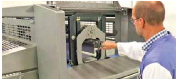
L'utilisation et la permutation d'outillages sont assurées par le logiciel Unique Fit Tooling. L'outillage plus léger et plus compact simplifie grandement sa manipulation et son démontage qui deviennent un jeu d'enfant et peuvent être effectués par une seule personne. Aucun autre dispositif n'est nécessaire pour aider l'opérateur à changer les outils.
