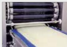
2. Quick réducteur : la première réduction de l'épaisseur de l'abaisse est réalisée par un Quick réducteur. Grâce à nos rouleaux non adhérents, nous sommes en mesure de traiter des types de pâtes à taux d'hydratation élevé.
