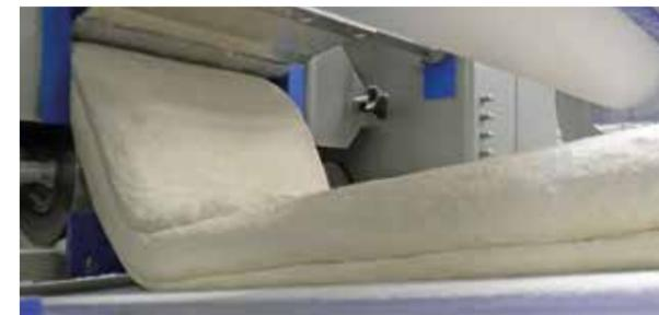
Élimination des hauteurs de chute : en minimisant la hauteur de transport sur toute la ligne de production, il en résulte une feuille de pâte stable et relâchée.
