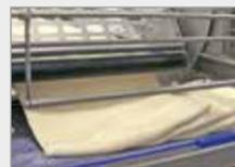
3. Laminage : pour obtenir une structure cellulaire plus fine et plus régulière et une pâte plus solide.
