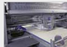
4. Calibreur transversal : permet de compenser la réduction unilatérale des unités de calibrage et pour ajuster l'épaisseur de la bande de pâte. La feuille de pâte diminue en épaisseur et augmente en largeur.
