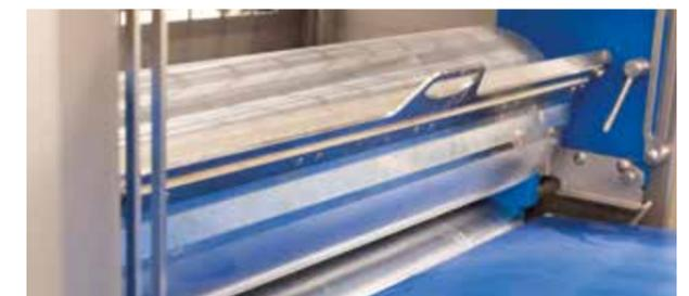
Racleurs de rouleaux résistants à l'usure pour maintenir les rouleaux des calibreurs aussi propres que possible.
