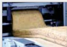
1. Extrusion de pâte à pain : production de bandes de pâte non stressées de tout type avec un excellent contrôle du poids et de la plus haute qualité. La structure de la pâte n'est pas affectée, car la pâte est manipulée avec délicatesse.
